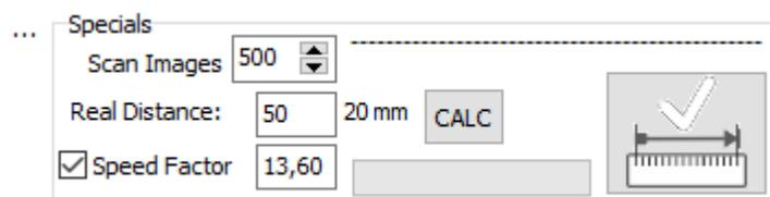
Le logiciel supporte un maximum de 500 images par scan. Pour les ordinateurs plus lents, une limitation en termes de mémoire ou vitesse comme le maximum de scan images doit être réglée à un nombre plus bas (par ex.. 200).
