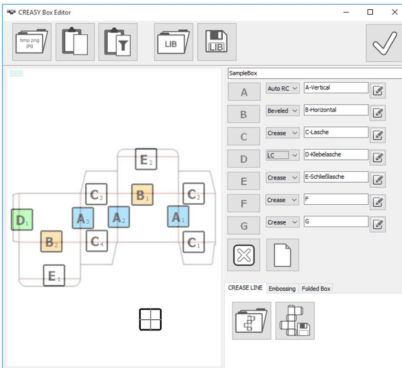
La boîte pliée peut avoir les différents types de plis : comme des plis simples, des coins ronds, des bords biseautés ou des plis laser gravés. Comme les algorithmes de mesure sont différents, le type de crease à mesurer doit être prédéfini à la position appropriée. Le type peut être choisi :
