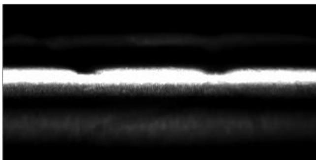
Presser le bouton de mesure de votre appareil. Le logiciel prend en photo l'image et détecte automatiquement les plages hautes et basses. Il va également mesurer les déviations de hauteur et calculer le gaufrage maximum. Le maximum sera mis en évidence en rouge.
