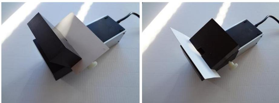
Il y a deux approches pour regarder le bord. Du haut (image gauche) et de l'avant (image droite). Il est important que vous utilisiez toujours la même approche pour obtenir des résultats de mesure répétables et comparables.
