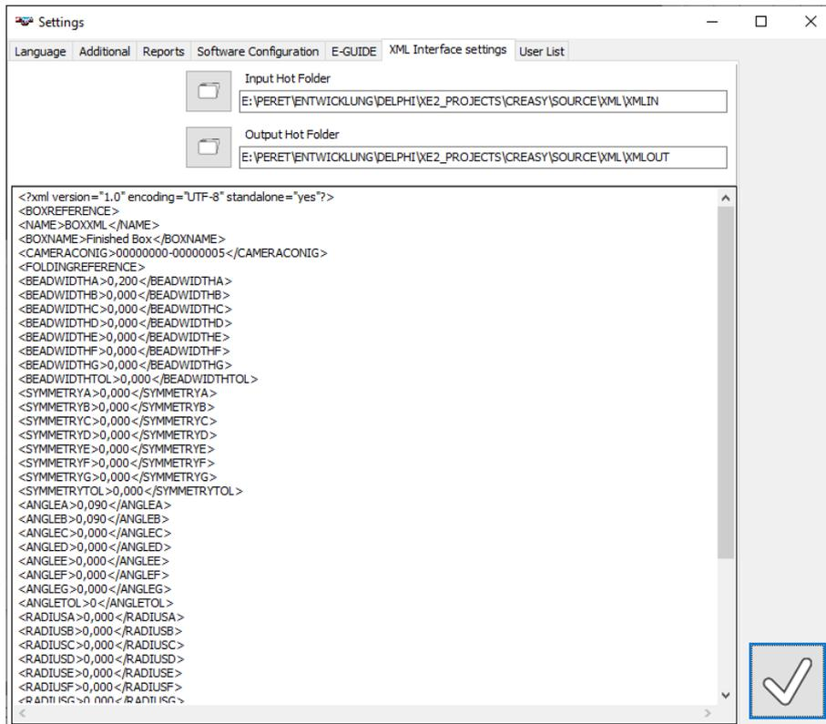
Le dossier d'entrée XML et le dossier de sortie XML sont sélectionnés dans la fenêtre des paramètres. Le fichier XML utilisé le plus récemment est imprimé dans le champ mémo.
