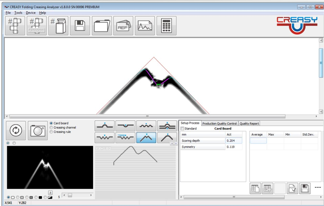
Maintenant la profondeur de la coupe peut être mesurée (lignes roses dans l'image ci-dessous)
