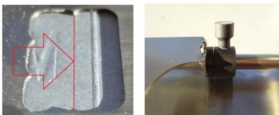
Fixer l'échantillon avec les aimants pour définir sa position afin de pouvoir positionner l'échantillon suivant au même endroit.
