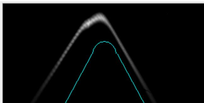
Vérifier la fenêtre "Aperçu" et s'assurer que le sommet du pli soit visible à l'intérieur de la fenêtre. Pour une plus grande précision de mesure, la résolution verticale de l'image est plus grande que la résolution horizontale. C'est pour cela que l'angle visualisé ressemblera plus à 60° qu'à 90°.
