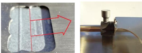
Déplacer le support jusqu'au bout de la plage refoulée et fixer la position avec l'autre vis.
