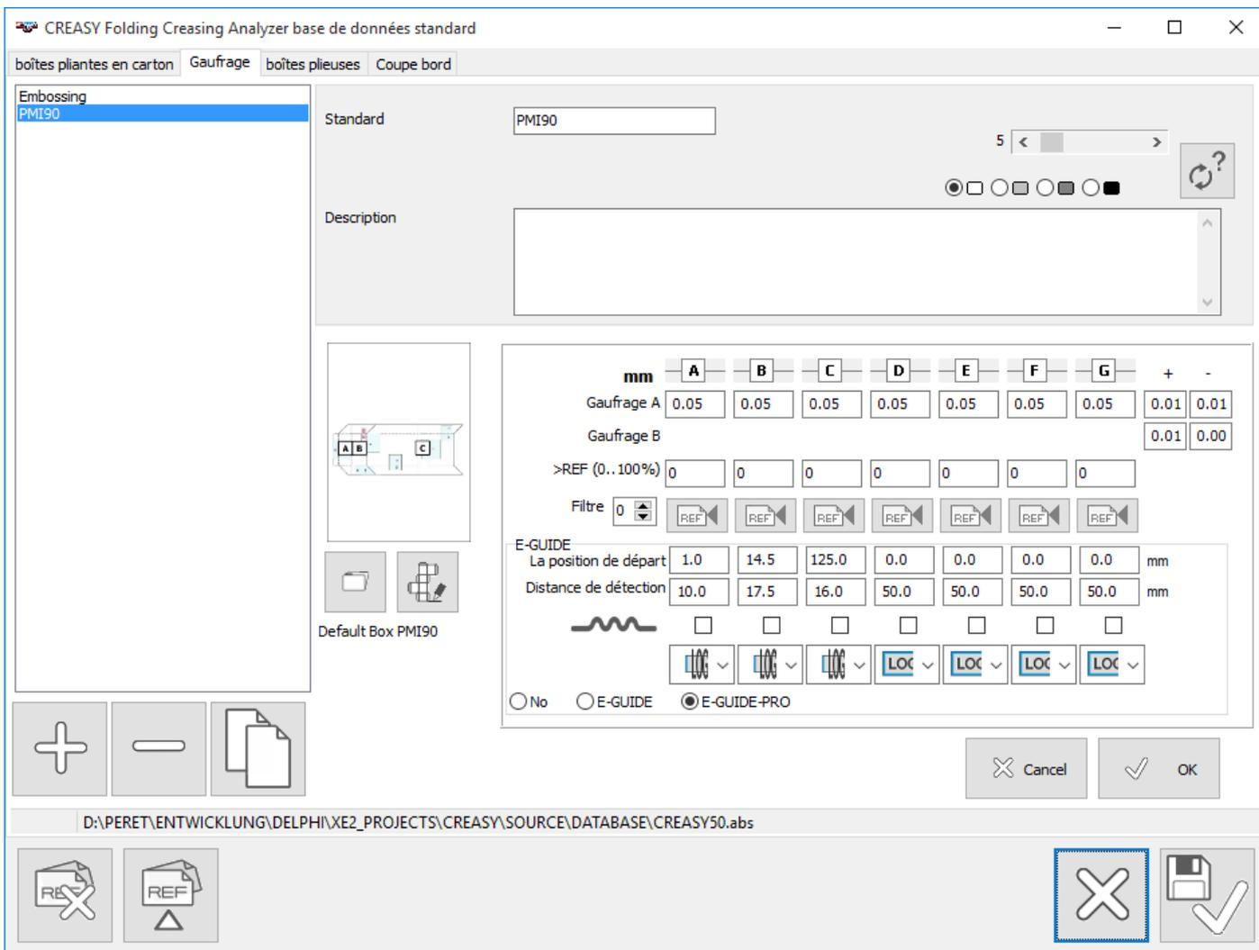
Les options EGUIDE et EGUIDE PRO demandent de plus de spécifications pour utiliser les ajustages adéquats durant les mesures. Elles seront automatiquement rappelées durant un processus de travail de mesures.
