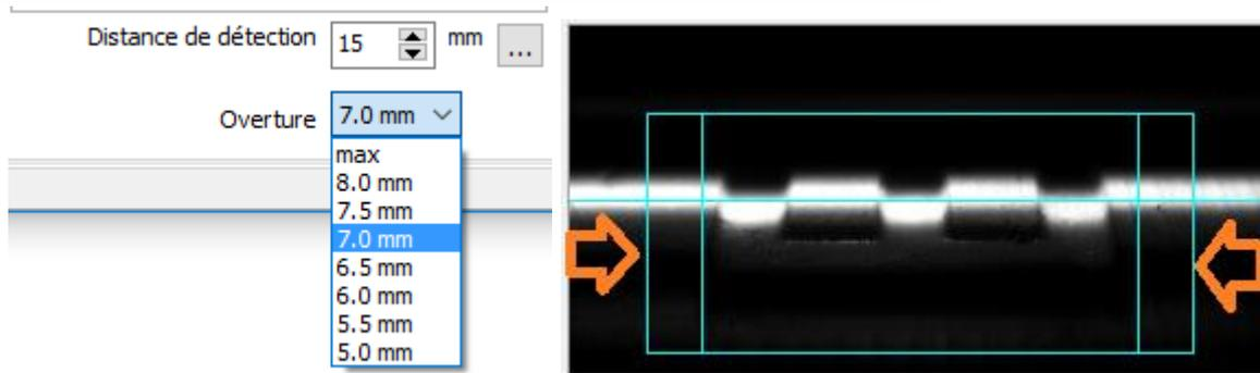
Maintenant bouger le chariot avec le CREASY monté manuellement au-dessus de la plage de gaufrage et vérifier si la plage de gaufrage est bien positionnée. Le chariot peut être bougé manuellement en pressant le bouton UNLOCK
