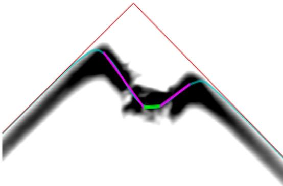
Si les plis ne sont pas faits correctement, le carton peut légèrement casser, montrant une partie plate entre les deux coupes ou visualisant les fibres du carton. De plus, si la longueur des deux lignes est très différente l'une de l'autre, la qualité du pli est mesurée en termes de symétrie (égale à la différence entre les 2 longueurs de lignes).
