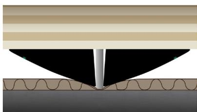
CITO Cushion Crease est utilisé sur le filet raineur pour faciliter la compression du carton ondulé et optimiser le pliage, en particulier le long de l'ondulation.
