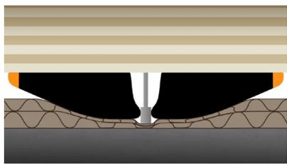
CITO Cushion Crease Plus est principalement utilisé pour le traitement des ondulations doubles et multiples. Le profilé de rainage est utilisé sur le filet raineur pour faciliter la compression du carton ondulé sur une surface plus importante et optimiser le pliage, en particulier le long de l'ondulation.
