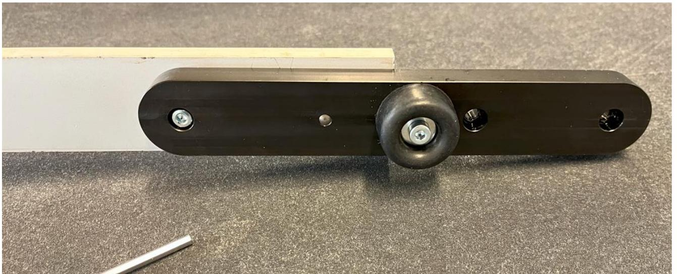
Nun können Sie die Lineal-Verlängerung montieren. Hierzu montieren Sie die Verlängerung mit den im Lieferumfang befindlichen zwei M4 x 12mm Zylinderschrauben mittels eines 3mm Sechskantschlüssels an der Stütze.
