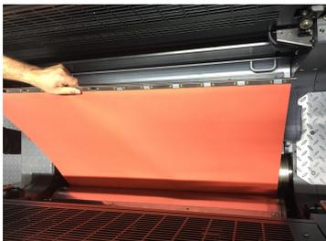
Fügen Sie nun die Vorderseite (mit der Aufnahme) in die Führung an der Greiferaufschlagsleiste ein. Das PrintGuardPlus wird durch seitliches Verschieben von AS zu BS eingehängt und gesichert. Stellen Sie sicher, dass das PrintGuardPlus durch das Verschieben fest arretiert ist und sich nicht aus der Greiferaufschlagsleiste ziehen lässt. Vergewissern Sie sich, dass das PrintGuardPlus zentriert auf dem Zylinder ist.
