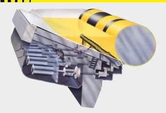
Le pellicole calamaio realizzate con precisione e con piegature esatte garantiscono un utilizzo rapido e sempre uniforme nel calamaio della vostra macchina da stampa. Grazie alla sua elevata stabilità, questa pellicola ad orientamento biassiale garantisce un trasporto sicuro e uniforme dell'inchiostro senza variazioni di colore o segni precoci di usura.
