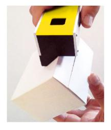
Con il nostro strumento di misurazione CITO CREASY potete verificare i rilievi delle cordonature. È utile durante la regolazione della macchina perché ottimizza le cordonature e incrementa la durata dei vostri utensili e matrici di cordonatura.
