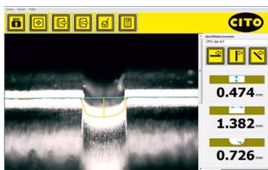
CITO CounterControl è un sistema di misurazione ottico di prossimità che consente di controllare la larghezza e la profondità del canale di cordonatura sulla lastra Pertinax e sulla piastra completa per la cordonatura.
