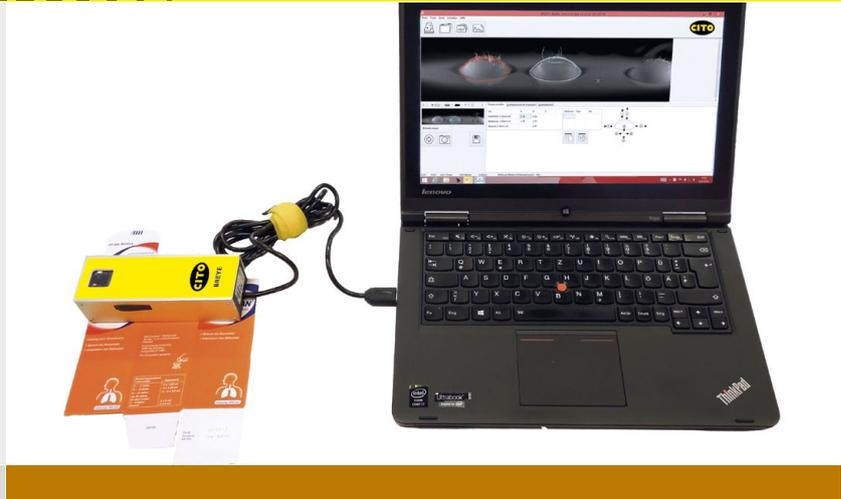
Das CITO BREYE wird über USB an einen PC angeschlossen. Es nimmt 3D-Bilder der Messprobe auf und sendet diese zur Analyse an den PC.
