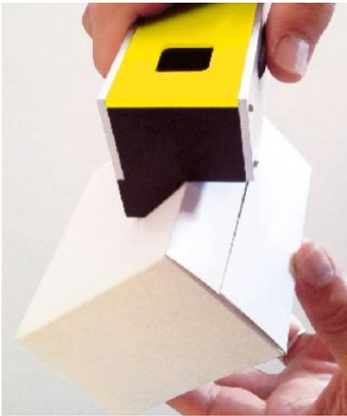
Notre appareil de mesure de rainures CITO CREASY vous permet de mesurer les formes de rainures. Il vous assiste lors de la mise en train de votre machine, dans le but d'optimiser les rainures et la durée de vie de vos outils et matrices de rainurage.
