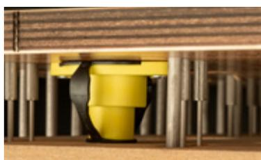
Speziell für den Einsatz in Ausbrechwerkzeugen mit Presserplatte zur Verarbeitung von Vollpappe und Wellpappe konzipiert
