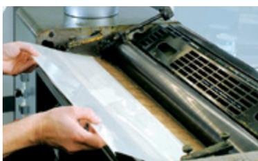
Präzise gefertigte und stabile Farbkastenfolien für CPC-Farbkasten und CPC-Farbdosiersysteme für Heidelberger Druckmaschinen.
