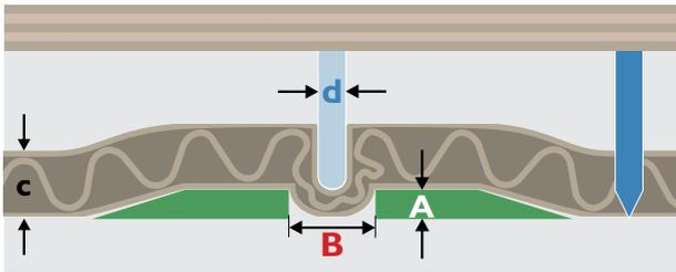
**A** = Rillkanaltiefe    **B** = Rillkanalbreite    **d** = Rillstahlbreite
