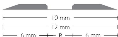
Rillzurichtung für hochwertige Wellpappenerzeugnisse. Abgeschrägte Innenkanten reduzieren die Zugspannung und verhindern so das Einreißen des Deckenmaterials.
