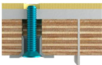
Zur sicheren Fixierung der Stanzform am Schließrahmen mit der passenden Schraube
